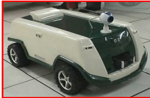
Figura 1 – Carroceria do RoboDeck .
